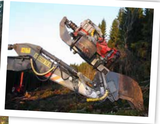
RASJONALISERING: En klembankelunner tar unna tømmeret fra de to banene og kjører det fram til en gravemaskin med hogstaggregat som opparbeider tømmeret fra begge banene.
