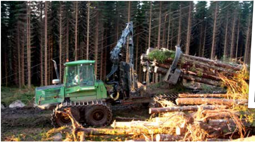
RASJONALISERING: En klembankelunner tar unna tømmeret fra de to banene og kjører det fram til en gravemaskin med hogstaggregat som opparbeider tømmeret fra begge banene.
